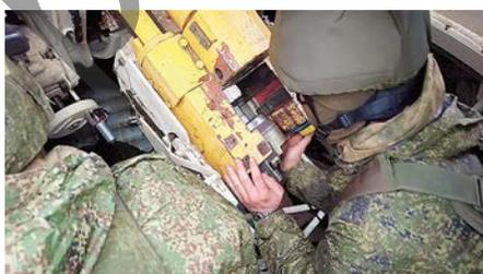
Досылание выстрела в казенник ствола. Хорошо виден запирающий механизм затвора с упругопластическим obturatorом. Заряжающий работает буквально «плечом к плечу» с наводчиком.
